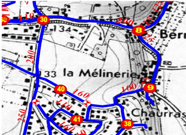
Réseau d'eau potable au droit du terrain
